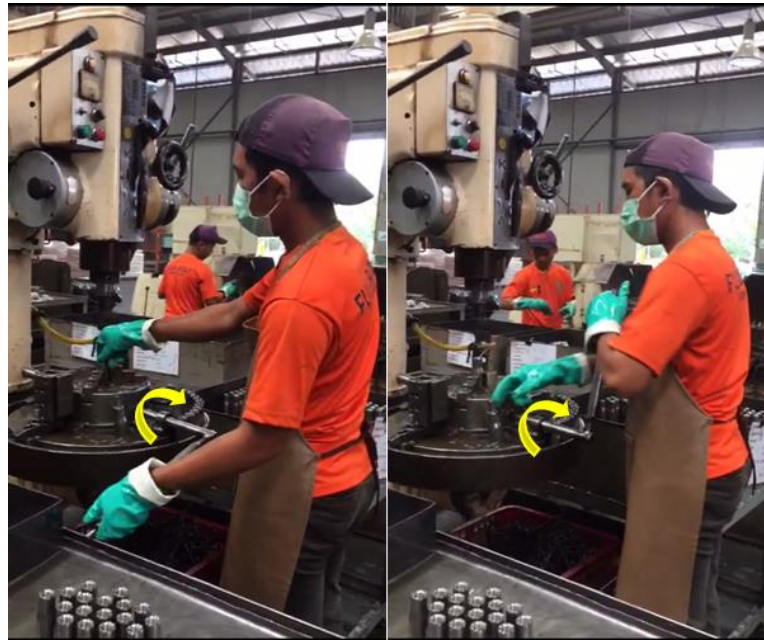
Gambar 16 Proses penjepitan manual pada mesin tapping
